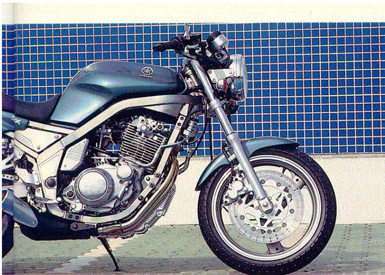
dans la petite liste des modifications. Egalement un grand bien côté suspension avec une fourche plus costaute et un mono amortisseur digne d'une moto de 1990. Pour améliorer la maniabilité, le double disque est remplacé par une unique galette de 320 mm pincée par un étrier quatre pistons.
